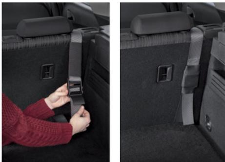
Schieben Sie den Gurt zwischen den Sitz und das Rückenpolster des Rücksitzes. Legen Sie die Schnalle so über die Rückenlehne des Rücksitzes, dass sie bis in den Kofferraum reicht. Ziehen Sie das Gurtende durch die Schnalle. Straffen Sie den Gurt und vergewissern Sie sich, dass die Schnalle fest geschlossen ist. Schieben Sie die elastische Hülle über die Schnalle.
