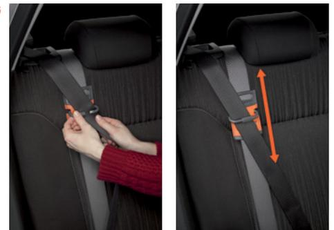
Öffnen Sie den Karabiner, legen Sie den Sitzgurt in den Karabiner ein und schließen Sie den Karabiner. Schieben Sie den Sitzgurt dann einfach in die gewünschte Höhe. Kinder und Erwachsene auf der Rückbank genießen dank der SAFETY BELT SOLUTION mehr Komfort und Sicherheit.
