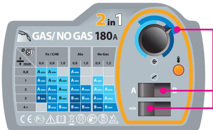
Die Einstellung der Schweißparameter erfolgt dank der intuitiven Bedienung in wenigen Sekunden.
