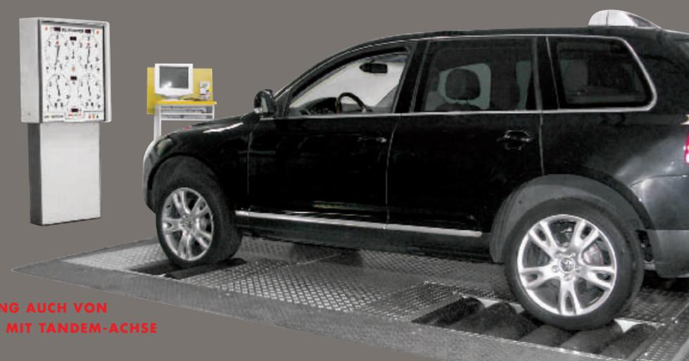
BREMSPRÜFUNG AUCH VON ANHÄNGERN MIT TANDEM-ACHSE MÖGLICH.
