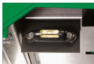
Mit Hilfe der Wasserwaagen-Libelle kann das SEG IV exakt parallel zum Untergrund ausgerichtet werden
