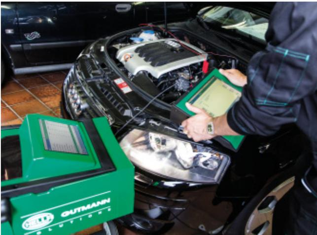
Im SEG V sind bereits ab Werk umfangreiche fahrzeugspezifische Daten und genaue Algorithmen hinterlegt, die Werkstätten für die schnelle und zuverlässige Einstellung komplexer Scheinwerfersysteme benötigen
