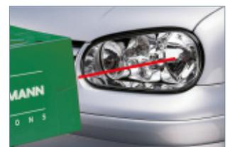
Über die integrierte Laser-Positionshilfe kann der Optikkasten schnell, bequem und exakt ausgerichtet werden
