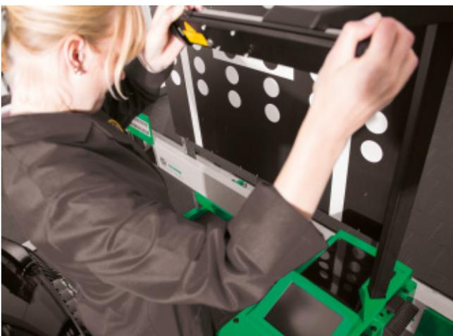
Bei einigen Fahrzeugen wird die Ausrichtung zur fahrdynamischen Längsachse empfohlen. Mit Hilfe des CSC-Tool ist diese Art der Einstellung problemlos möglich.
