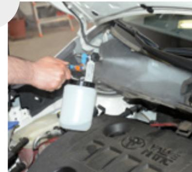
5. Ouvrez le capot moteur et retirez le filtre d'habitacle. Si nécessaire, nettoyez le boîtier du filtre à pollen et désinfectez-le. Mettez la ventilation en marche sur le niveau 1 et pulvérisez le désinfectant dans l'habitacle par l'orifice d'aspiration d'air du système de chauffage, ventilation et climatisation. Introduisez du produit jusqu'à ce que le brouillard soit visible dans tout l'habitacle. Laissez le brouillard agir pendant env. 1 minute.
