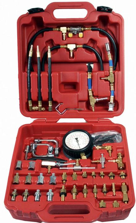
5. Druckprüfung von Einspritzanlagen
