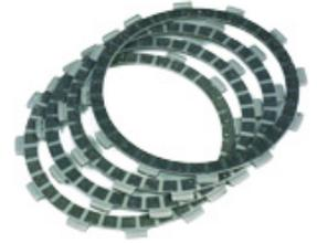
**Tipp:** Kupplungslamellen vor dem Einbau einige Zeit in Motoröl einlegen!
