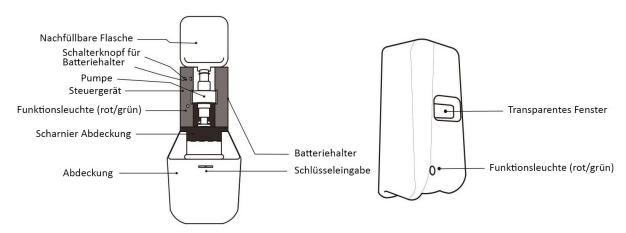
Wenn die Abdeckung geöffnet ist, schaltet sich der Schalterknopf für Batteriehalter automatisch aus.
