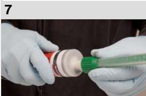
Statikmischer aufsetzen und mit Überwurfmutter anschrauben.
