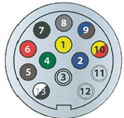
Kontaktbelegung 7-poligen Stecker entspricht DIN ISO 1724 und 13-poligen Stecker entspricht DIN ISO 11446
