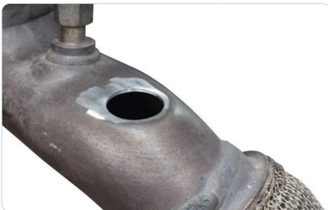
5. Bohrung entgraten. Bohrspäne sorgfältig entfernen.
