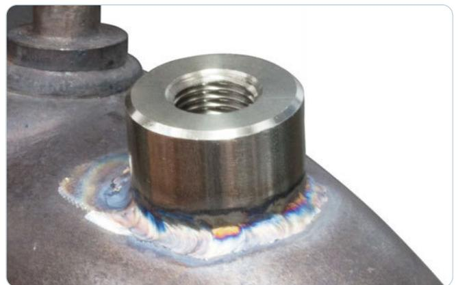
6. HJS Reperaturanschluß einsetzen und verschweißen.
