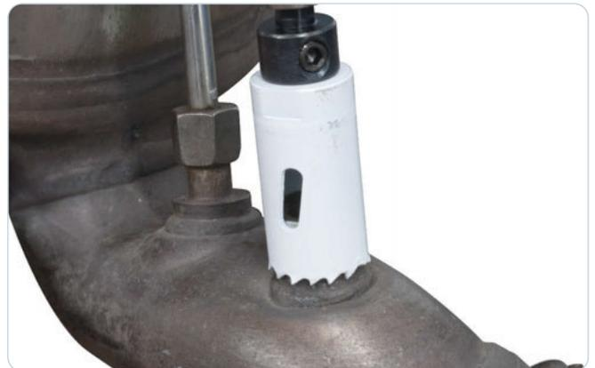
4. Temperatursensoranschluss mit einer Lochsäge (Ø 25 mm) **ohne** Zentrierbohrer ausschneiden.
