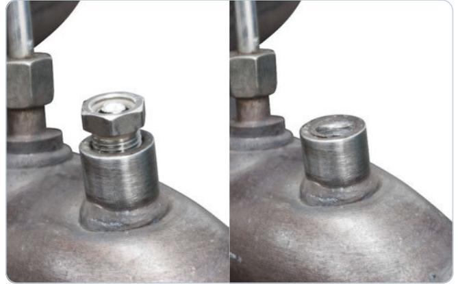
2. Links: Nach Entfernen der Sensorleitung
