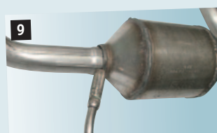
9 Neues Reparaturrohr verschweißen.
