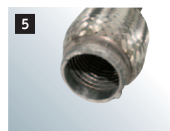
5 Wenn Öffnung gereinigt ist (alle Reste vom alten Rohr müssen entfernt sein), kann das neue Reparaturrohr problemlos eingeschoben werden.
