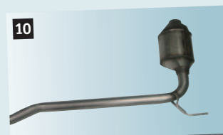
10 Clevere Reparaturlösung: Neues Reparaturrohr am funktionsfähigen „alten“ KAT.
