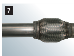
6 Neues DIN-Rohr ca. 10 mm tief in das Flexrohr einschieben und dann verschweißen.
