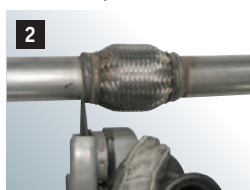
2 An der gekennzeichneten Stelle (hinter der Schweißnaht) altes Rohr mit der Flex abtrennen.
