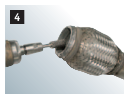
4 Schweißnaht mit dem „Schnellläufer“ auffräsen, bis sämtliche Reste vom alten Rohr entfernt werden können. Sorgfältig arbeiten!
