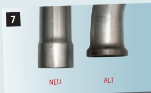
7 Neues Reparaturrohr ist länger als das alte abgeschnittene Rohr.
