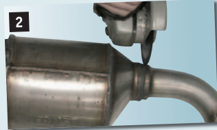
2 An der gekennzeichneten Stelle (hinter der Schweißnaht) altes Rohr mit der Flex abtrennen.
