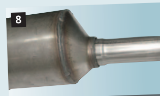
8 Das längere Reparaturrohr ca. 10 bis 15 mm tief in den Konus des KATs einschieben.
