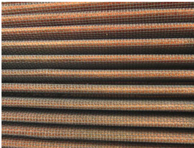
K&N Luftfilter, der gereinigt und wieder eingölt wurde
