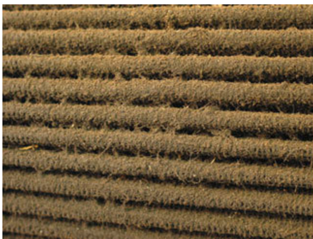
Schmutziger K&N Luftfilter, der gereinigt werden MUSS
