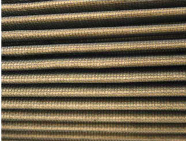
K&N Luftfilter, der gereinigt wurde und NOCH NICHT eingölt wurde
