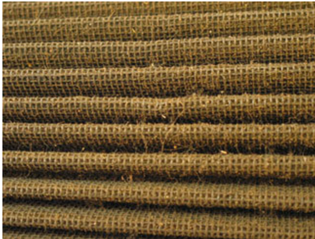
Schmutziger K&N Luftfilter, der NOCH NICHT gereinigt werden muss
