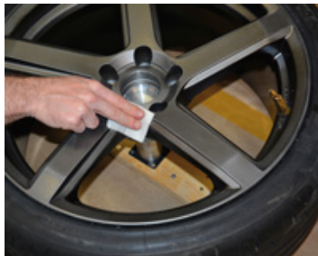
Bsp3 Oberfläche mit Reinigungstuch entfetten.
