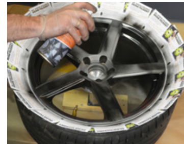
Bsp5 Das Universal 2K Lackspray in 2 - 3 Spritzgängen dünn aufspritzen.
