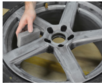
Bsp1 Rad abmontieren, Felge reinigen und mit beiliegendem Schleifschwamm anrauen.
