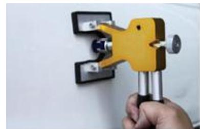
Entfernen Sie den Klebe-Pad und den restlichen Heiß-Kleber mit einer, handelsüblichen 90% Aceton-Wasser-Lösung. Nach dem Reinigen sollte die Oberfläche poliert werden.
