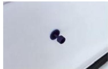
Verbinden Sie den Mini Beulenzieher über die Nut mit dem Klebe-Pad und justieren Sie die Höhe mit der Einstellschraube.
