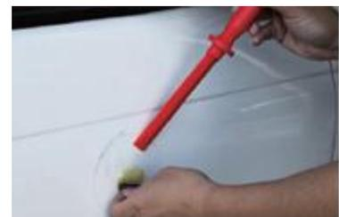
Entfernen Sie die verbleibende Klebeschicht von der Oberfläche und polieren Sie den Bereich der Oberfläche an dem der Klebe-Pad gesessen hat.
