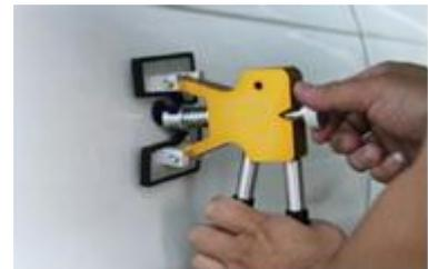
Betätigen Sie, durch zusammenpressen der Griffstücke, den Mini Beulenzieher langsam und stetig, bis die Oberfläche wieder eben ist.
