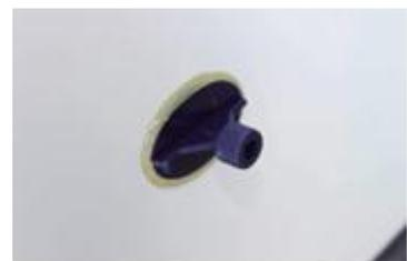
Wenn der der Klebe-Pad plaziert ist, verbinden Sie den Gleithammer mit dem Klebe-Pad. Der Gleithammer hat eine Nut in den der Klebe-Pad eingehängt wird. Betätigen Sie den Gleithammer langsam und stetig, bis die Oberfläche wieder eben ist.
