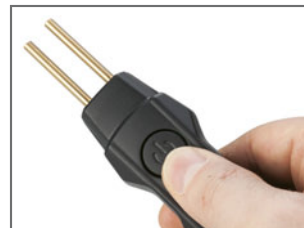
3. Legen Sie die Klammer ein und drücken Sie den Betätigungsknopf für die Reparatur.
