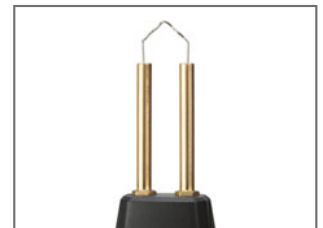
4. Nach 3 Sekunden die Klammer in den Kunststoff drücken.
