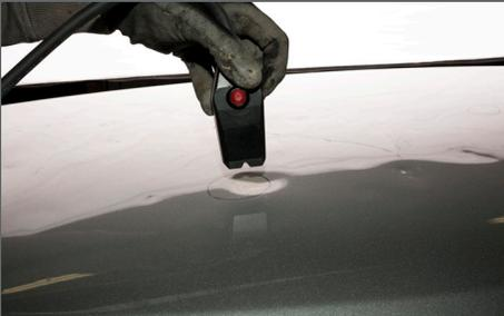
5. Die Taste am Zubehör betätigen. Ein akustisches Signal weist daraufhin, dass das Gerät in Betrieb ist. Der Betrieb des Zubehörs und somit auch das akustische Signal werden nach einer begrenzten Zeit von ca. 0,5 s unterbrochen.
