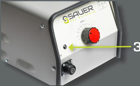
**Achtung:** Wenn die LED zu blinken beginnt, bedeutet das, dass die Maschine in den Schutzmodus übergegangen ist. Die Maschine dann mit der On/Off-Taste an der Rückseite abschalten, 10 Sekunden warten, und sie wieder einschalten. Bleibt das Problem bestehen, den Kundendienst benachrichtigen.
