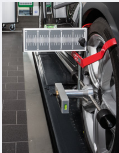
CSC-Tool mittig und parallel zum Fahrzeug ausrichten
