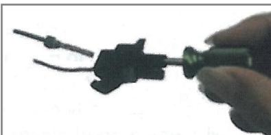
Die Steckkontaktsicherungen werden gelöst und der Kontakt kann aus dem Steckergehäuse herausgezogen werden.
