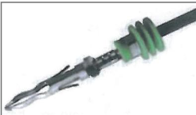
Verbinder mit dem Kabel und der Kabeldichtung in die Crimpzange einlegen und durch betätigen der Zange den Crimpvorgang durchführen. Nach dem Crimpen die Kabelverbindung auf guten Kontakt überprüfen, sowie die Position und Klemmung des Kabels mit der Kabeldichtung kontrollieren.
