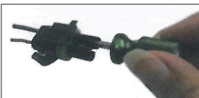
Wenn das Steckerdemontagewerkzeug richtig positioniert ist, durch Druck den Steckverbinder aus dem Steckergehäuse drücken.
