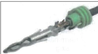
Kabel in den Verbinder positionieren. Das abisolierte Kabelende muss in der dafür vorgesehenen Position sein (vordere Klammerbacken) und das noch isolierte Kabel dort wo die Zugentlastung sein soll (hintere Klammerbacken). Am hinteren Teil wird mit dem Kabel auch die Kabeldichtung gecrimpt.
