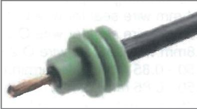
Entsprechende Dichtung über das Kabel ziehen (auf Kabelquerschnitt und Montagerichtung achten) und das Kabelende abisolieren. Die Länge der Abisolierung richtet sich nach dem zu verwendeten Stecker.
