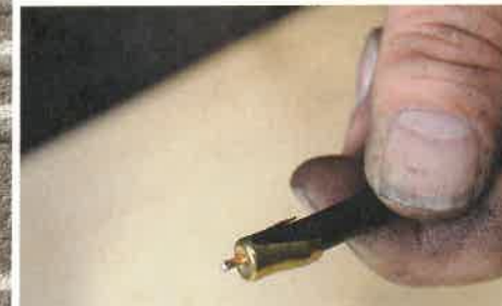
Der Anschluss der Verteilerkappe wird gelötet. Hierzu lässt man das abisolierte Kabel etwas herausstehen...
