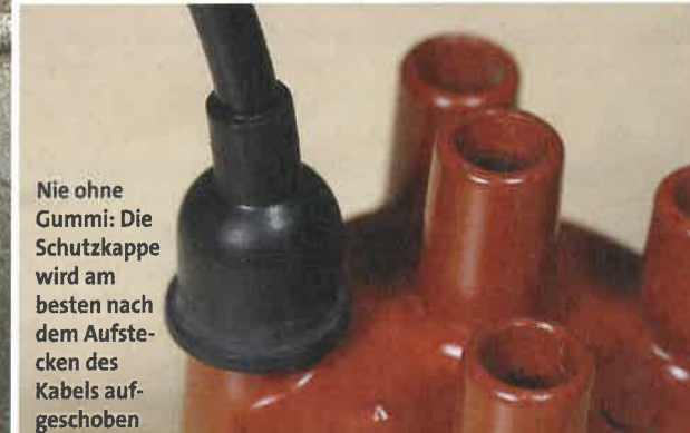
Der Anschluss der Verteilerkappe wird gelötet. Hierzu lässt man das abisolierte Kabel etwas herausstehen...
