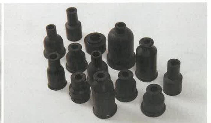
Je nach Einsatzzweck gibt es dutzende Kerzenstecker-Versionen, teils mit erhöhtem Widerstand, teils mit Abschirmung und auch in unterschiedlichen Längen – je nach dem, wie die Einbaulage der Zündkerze es erfordert. Die Gummikappen verhindern das Eindringen von Feuchtigkeit am Übergang des Kabels zur Kappe
