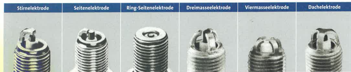
Je nachdem, wie die Konstruktion eines Motors es erfordert, verläuft der Zündfunke. Über die unterschiedlichen Elektroden wird er kontrolliert: Einfache Stirn- und Seitenelektroden sind das häufigste Prinzip. Bei Mehrfachelektroden springt der Funke nach dem Zufallsprinzip über – aber stets zum richtigen Zeitpunkt
