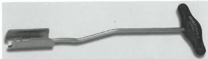
An Kerzensteckern zu hantieren, kann selbst bei stehendem Motor gefährlich sein – wenn er betriebswarm ist. Spezialwerkzeug schützt vor Verbrennungen
