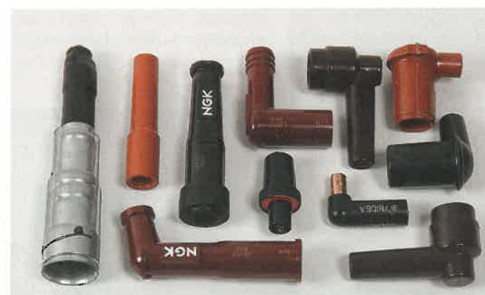
Je nach Einsatzzweck gibt es dutzende Kerzenstecker-Versionen, teils mit erhöhtem Widerstand, teils mit Abschirmung und auch in unterschiedlichen Längen – je nach dem, wie die Einbaulage der Zündkerze es erfordert. Die Gummikappen verhindern das Eindringen von Feuchtigkeit am Übergang des Kabels zur Kappe
