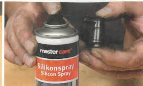
Die Stecker werden ins Kabel geschraubt, etwas Silikonspray erleichtert die Montage erheblich
