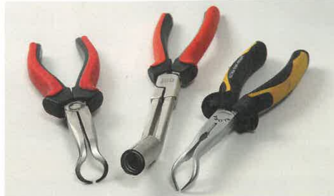
Kerzenkabel bei laufendem Motor sollten nur mit (isolierten!) Zangen berührt werden – es gibt diverse Ausführungen, die stets am Stecker zupacken
