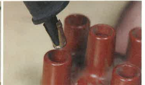
...Kabel zugfest mit ihr verbunden ist. Die Hülse soll in der Verteilerkappe festsitzen aber nicht verkeilen
