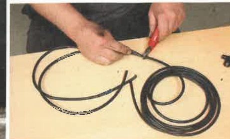
Noch immer gibt es Zündleitung als Meterware. Der Nachbau passender Kabel ist nicht schwierig
