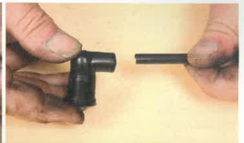
Je nach Ausführung kommt auch über den Stecker noch eine Gummi-Schutzkappe. Hier jedoch nicht
