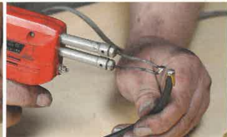
...fächert die Kupferdrähte des Kabels auf und verlötet sie auf der Messinghülse, sodass das...
