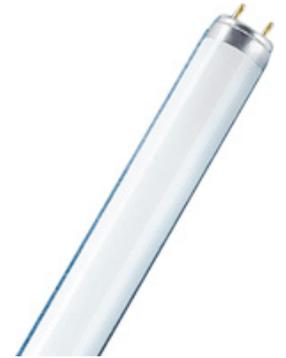
Leuchtstofflampen in Lumilux und Standardlichtfarben haben gegenüber den früheren L-Lampen mit 38 mm Rohr Ø bis zu 10% geringere Leistungsaufnahme und nur noch 26 mm Rohr Ø. Sie sind für Betriebe an Startern und am HF-Betriebssystem Quiktronic DeLuxe konzipiert. In Starterschaltung können diese Lampen ohne Änderung der Vorschaltgeräte und Kompensations-Kondensatoren eingesetzt werden.
