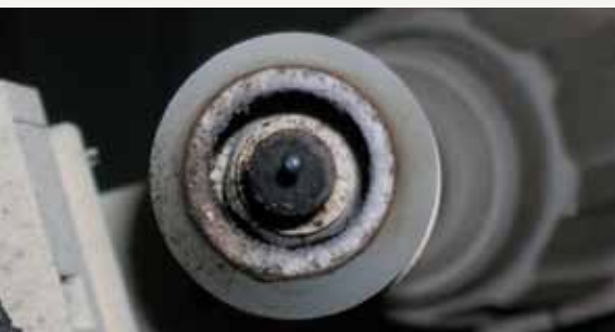
Unterschied, mit und ohne Schutzbeschichtung, nach 75 Minuten Schweißen
