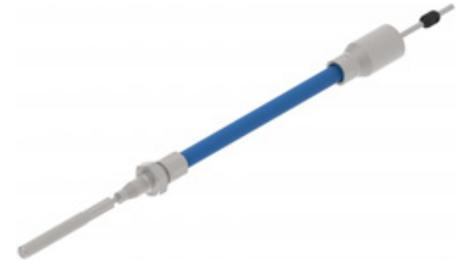
Für KNOTT-Bremse 160x35 200x50 250x40
