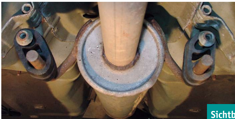
Naturkautschuk (links) und EPDM (rechts) im direkten Vergleich und Langzeittest beim Mittelschalldämpfer Opel Corsa C.
